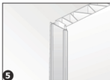
5 Coluna de reforço (passo 1)
