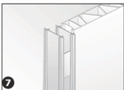
7 Coluna de reforço (passo 3)
